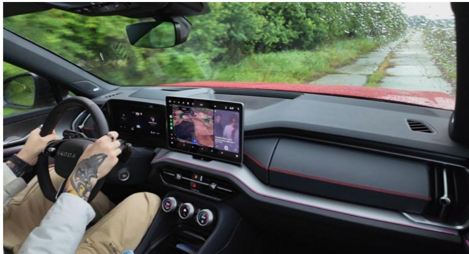
umiestnených pod centrálnym displejom. Krajné dva slúžia primárne na ovládanie klimatizácie a vyhrievania či prípadne ventilácie sedadiel, zatiaľ čo stredný je konfigurovatelný a dokáže ovládať rôzne funkcie ako, napríklad, hlasitosť audiosystému, zoom mapy navigácie, jazdné režimy či rýchlosť ventilátora. Každý z týchto ovládačov má v sebe malý a krásne
