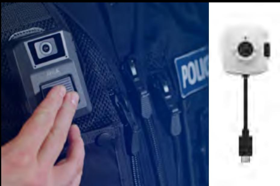
**Spoločnosť Axis Communications uviedla miniatúrny klopový senzor AXIS TW1201 nositel'ný na tele, ktorý sa prípája ku kamere AXIS W100. Je ideálny na uchytenie napr. na tričko alebo košel'u.**
