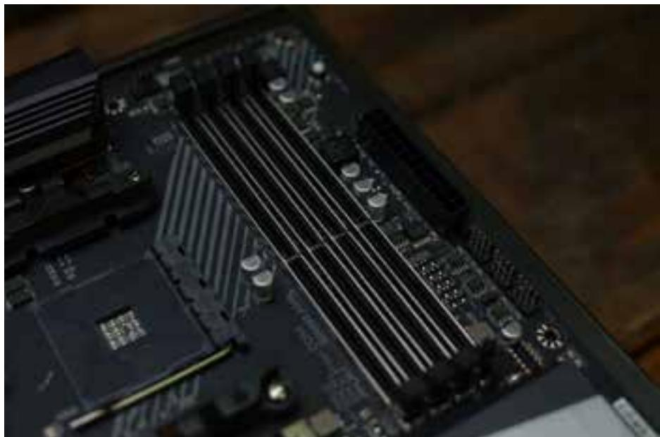
dosky osadiť novšími a výkonnejšími procesormi. Celá kompatibilita ale záleží od výrobcu dosky a jeho ochote vydáť nové BIOS ovládače. Nový X570 chipset je však v mnohom zaujímavý, keďže prináša nielen nové štandardy PCIe 4.0 a M.2 Gen 4, ale napríklad aj podporu Wi-Fi 6 a 10 Gigabit Ethernetu.
