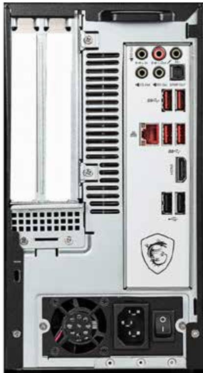
ventilátora, port na napájanie a perforácia na výstup teplého vzduchu zo skrine.
