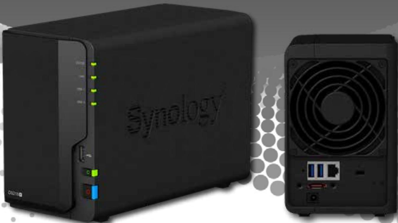
■ Synology DS218 + obsahuje prevodný systém s hardvérovou akceleráciou a podporuje kodeky H.264/H.265 1080p a H.265 4K. Prevádza 4K videá na 1080p, aby sa dali prehrať na zariadeniach bez podpory 4K a pri nižšej rýchlosti, či už ide o miestne prehrávače médií alebo vzdialené mobilné zariadenia. Okrem toho môžete prenášať videá v pôvodnom 4K rozlíšení do svojho multimediálneho prehrávača alebo 4K televízora v rámci miestneho sieťového prostredia.
