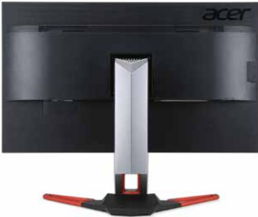
Zamrzí absencia rotácie, respektíve pivot, no monitor je vybavený štandardným systémom VESA pripojenia, a tak je možné osadiť ho na vlastný stojan alebo rameno a získať túto funkcionálnosť dodatočne.
