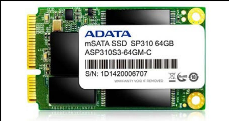
Spoločnosť ADATA Technology oznámila uvedenie pamäťového úložiska Premier Pro SP310 mSATA. Disk je určený pre spotrebiteľov, ktorí hľadajú cenovo výhodný upgrade s rozhraním SATA III a podporuje technológiu Smart Response Technology (SRT) spoločnosti Intel, ktorá umožňuje používať mSATA SSD v spojení s tradičnými pevnými diskami ako disky cache. Táto hybridná konfigurácia potom dosahuje zrovnateľné rýchlosti prenosu dát ako systémy, ktoré používajú SSD disk ako primárny.
